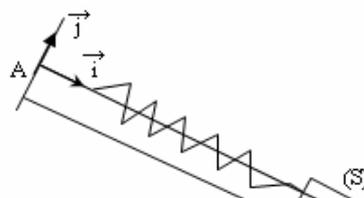
Le solide est attaché à l'extrémité inférieure d'un ressort de masse négligeable, à spires non jointives et à réponse linéaire ; l'autre extrémité du ressort est fixée en A (voir figure). On prendra  $g = 10 \text{ m/s}^2$ .
