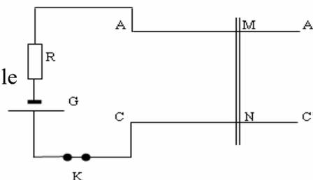
perpendiculairement aux deux rails AA' et CC' ; K est un interrupteur.
