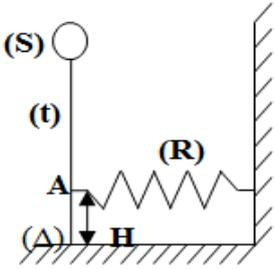
On désigne par J le moment d'inertie du système par rapport à l'axe ( $\Delta$ ). Quand la tige est verticale le ressort n'est ni allongé ni comprimé et son axe reste horizontal durant le mouvement. On néglige tout frottement.
