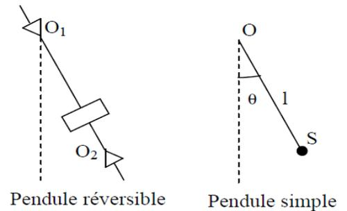
**1.** Le pendule simple, écarté de sa position d'équilibre puis abandonné à lui-même oscille dans un plan vertical. Soit  $\theta$  l'angle qu'il fait à un instant t avec la verticale passant par O et V la vitesse du solide S.
