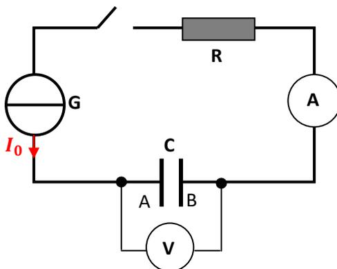
La valeur de l'intensité  $I_0$  étant fixé à 0,1 mA. On ferme l'interrupteur et on déclenche simultanément un chronomètre. Les valeurs de  $u_{AB}$  sont relevées toutes les 20 secondes. On obtient les valeurs suivantes :
