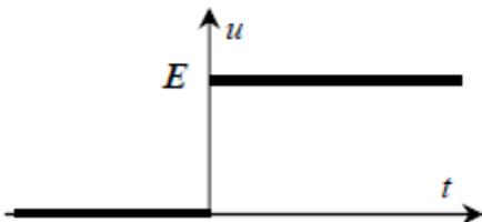
La réponse d'un dipôle RC soumis à un échelon de tension est le comportement électrique de ce dipôle. Ce comportement peut être caractérisé par l'évolution de la tension aux bornes de ce dipôle, par l'évolution de l'intensité du courant dans ce dipôle ou par la variation de la charge prise par le condensateur au cours du temps.
