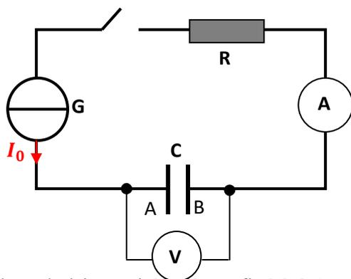
La valeur de l'intensité  $I_0$  étant fixé à 0,1 mA. On ferme l'interrupteur et on déclenche simultanément un chronomètre. Les valeurs de  $u_{AB}$  sont relevées toutes les 20 secondes. On obtient les valeurs suivantes :
