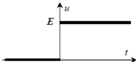
La réponse d'un dipôle RC soumis à un échelon de tension est le comportement électrique de ce dipôle. Ce comportement peut être caractérisé par l'évolution de la tension aux bornes de ce dipôle, par l'évolution de l'intensité du courant dans ce dipôle ou par la variation de la charge prise par le condensateur au cours du temps.
