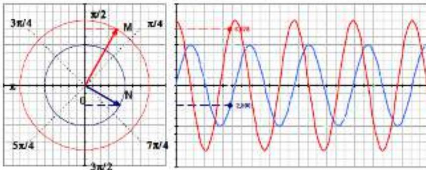
Dans l'exemple:  $\overrightarrow{OM} = 8 \sin\left(\omega t + \frac{\pi}{2}\right)$  et  $\overrightarrow{ON} = 5 \cdot \sin(\omega t)$
