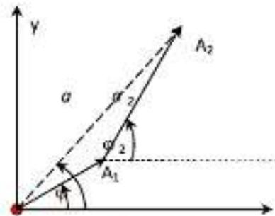
$y = y_1 + y_2 = a \cdot \sin(\omega t + \varphi)$  où  $a$  et  $\varphi$  sont des constantes déterminées par le calcul ou graphiquement.
