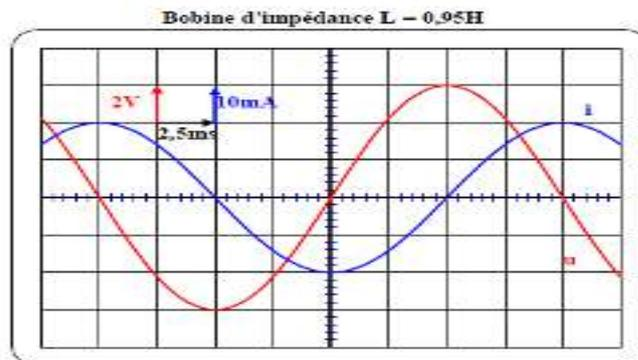
On détermine graphiquement le déphasage par la relation:  $\left\{ \begin{array}{l} 2\pi \rightarrow T \\ \varphi \rightarrow t \end{array} \right. \Rightarrow \boxed{\varphi = \frac{2\pi t}{T}}$
