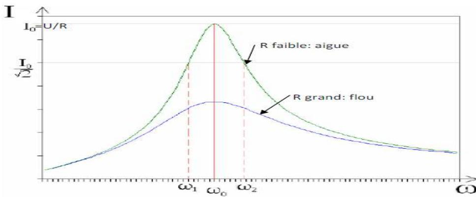
Cette courbe est appelée courbe de résonance.  $\omega_0 = 2\pi N_0$  est la fréquence de résonance, où  $I$  est à
