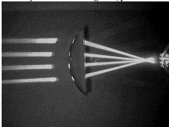
En retournant la lentille face pour face, les rayons convergent au même point .La lentille est optiquement symétrique.
