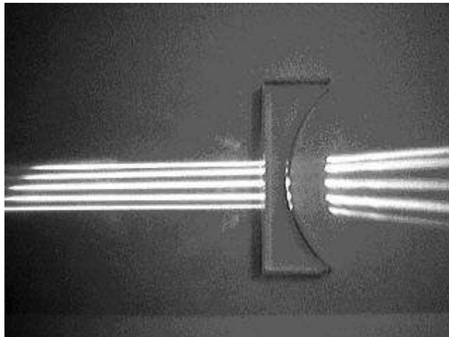
En retournant la lentille face pour face, l'effet sur les rayons lumineux est identique. La lentille est optiquement symétrique.
